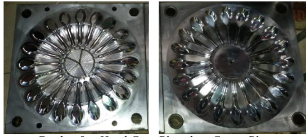
Gambar 8 : Hasil Core Plate dan Cavity Plate
